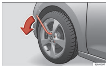
Fig. 131 Hjulskift: Sådan løsnes hjulboltene.
