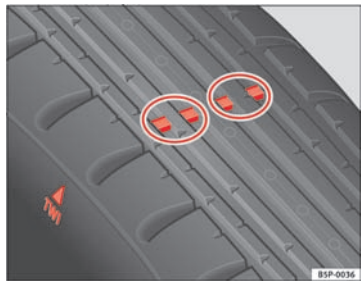
Fig. 124 Dækprofil med slidindikatorer
