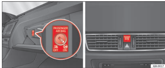
Fig. 24 Kontakt til forsædepassagerens frontairbag/kontrollampe til frakobling af forsædepassagerens frontairbag
