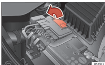
Fig. 209 Batteri: åbning af afdækning
