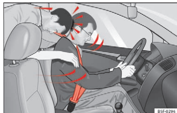
Fig. 78 En bagsædepassager, der ikke har sikkerhedssele på, bliver kastet fremad og ind i den fastspændte fører.
