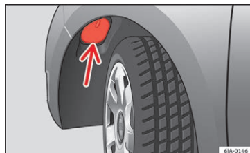
Fig. 90 Udskiftning af pære til nærlys: hjulkasse
