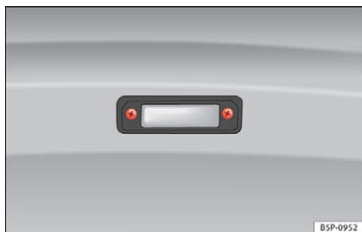
Fig. 106 Afmontering af nummerpladelygte
