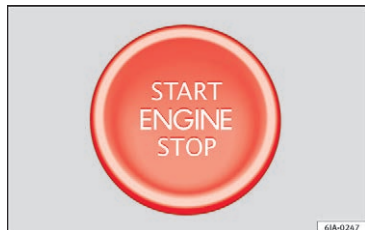
Fig. 171 I ratstammen: startknap til det nøglefrie låse- og startsystem Keyless Access. I højrestyrede biler er placeringen symmetrisk.
