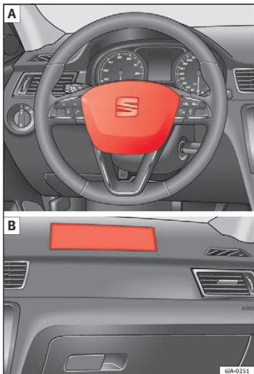
Fig. 15 Frontairbag til fører i rattet og frontairbag til forsædepassager i instrumentpanelet
