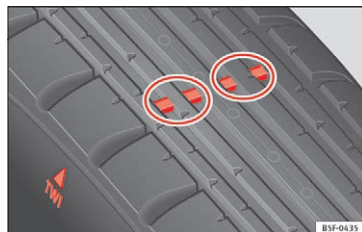
Fig. 211 Dækprofil med slidindikatorer
