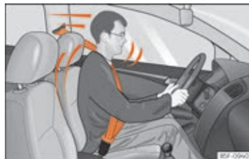
Fig. 76 Hvis sikkerhedssele er spændt korrekt, bliver føreren ikke kastet frem ved en pludselig opbremsning.
