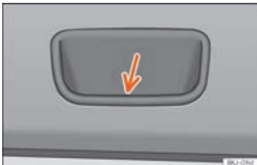
Fig. 127 Udsnit af bagklappens indvendige beklædning: greb til at lukke bagklappen med
