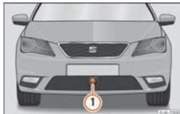
Fig. 224 | Forreste stødfanger: radarsensor
