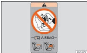
Fig. 26 På passagerdørrammen bagest: mærkat med angivelser vedr. airbaggen
