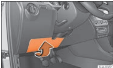
Fig. 55 Instrumentpanelet i førersiden: afdækning på sikringsboks
