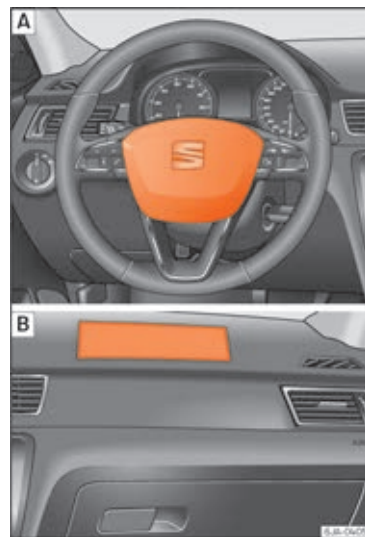
Fig. 18 Frontairbag til fører i rattet og frontairbag til forsædepassager i instrumentpanelet
