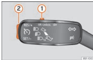
Fig. 42 På venstre side af ratstammen: kontakter og betjeningslementer til fartpiloten
