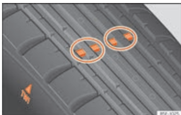
Fig. 250 Dækprofil med slidindikatorer
