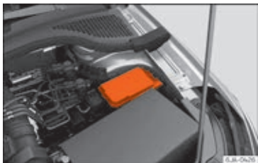
Fig. 56 I motorrummet: afdækning på sikringsboks
