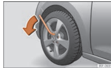
Fig. 63 Hjulskift: løsning af hjulbolte »»
