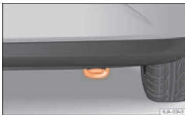
Fig. 67 Højre side af den bageste stødfanger: slæbeøjje
