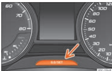
Fig. 112 Kombiinstrument: kilometertæller og nulstillingsknop
