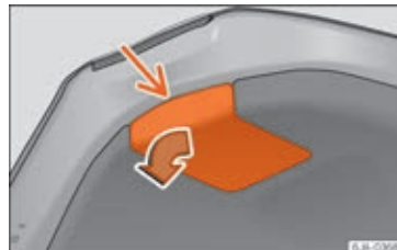
Fig. 104 Afmontering af afdækning på bagklappen
