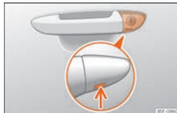
Fig. 5 Førerdørens dørhåndtag: skjult låsecylinder
