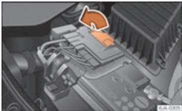
Fig. 248 Batteri: åbning af afdækning
