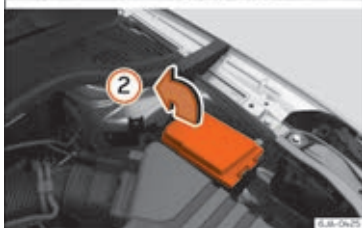
Fig. 88 I motorrum: sikringsboksens afdækning – variant 2
